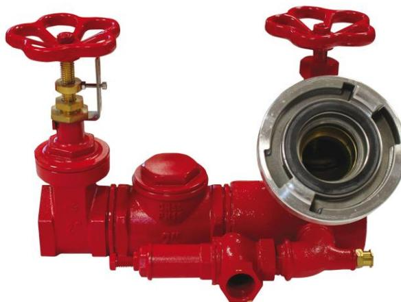
L'attacco di mandata per autopompa è un dispositivo, collegato alla rete di idranti in derivazione, per mezzo del quale può essere introdotta acqua nella rete di idranti in condizioni di emergenza.
