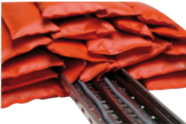
Rivestito da fibra di vetro trattata superficialmente e riempita con un miscela di fibre minerali ed agenti espandenti, che esposti al calore del fuoco prima si espandono e poi si induriscono per fornire una completa e duratura sigillatura contro il passaggio del fuoco, fumo e gas caldi.
