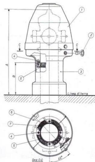
Cofano di protezione idranti in tre parti in alluminio, colore rosso con banda rinfrangente bianca.
