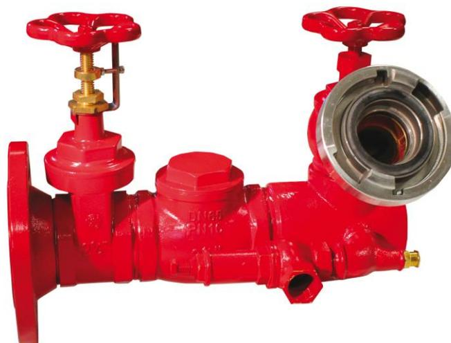
L'attacco di mandata per autopompa è un dispositivo, collegato alla rete di idranti in derivazione, per mezzo del quale può essere introdotta acqua nella rete di idranti in condizioni di emergenza.
