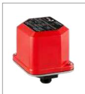
I pressostati sono progettati per l'uso in Impianti Sprinkler automatici a umido, a secco, a diluvio ed a preazione per indicare la scarica da uno sprinkler. I pressostati supervisione sono progettati per l'uso in sistemi a secco ed a preazione per monitorare la pressione dell'aria del sistema, fornendo un segnale d'aria ad alta vigilanza oltre alla condizione di allarme di bassa pressione.
